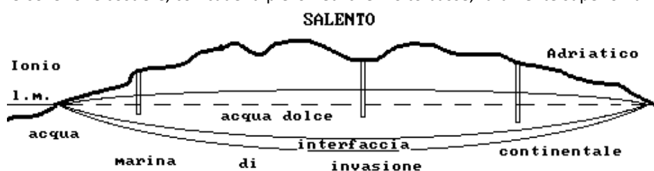
Figura 12 Sezione idrologica della Penisola Salentina
