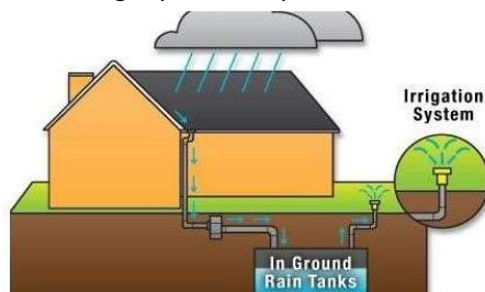
Figura 29 - Schema di funzionamento del sistema di riutilizzo delle acque meteoriche
