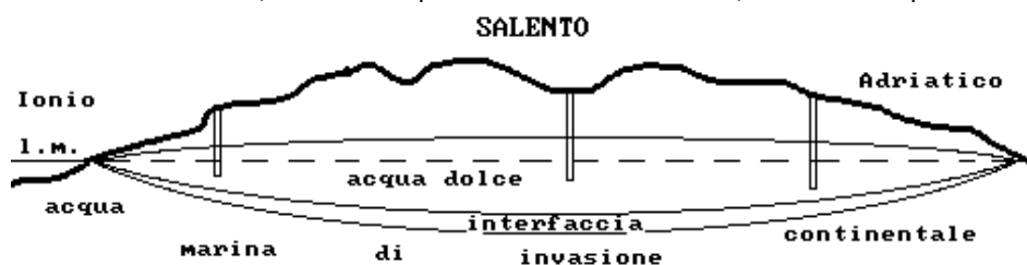
Figura 12 Sezione idrologica della Penisola Salentina
