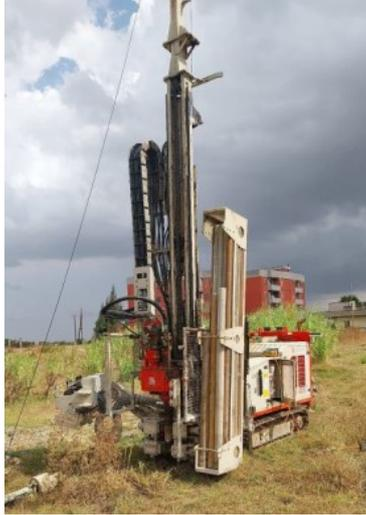
Le prove geognostiche, condotte mediante carotaggi continui e prove Lefranc di permeabilità in fori, hanno evidenziato quanto segue:
