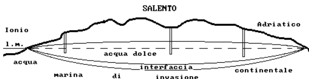
Figura 13 Sezione idrologica della Penisola Salentina
